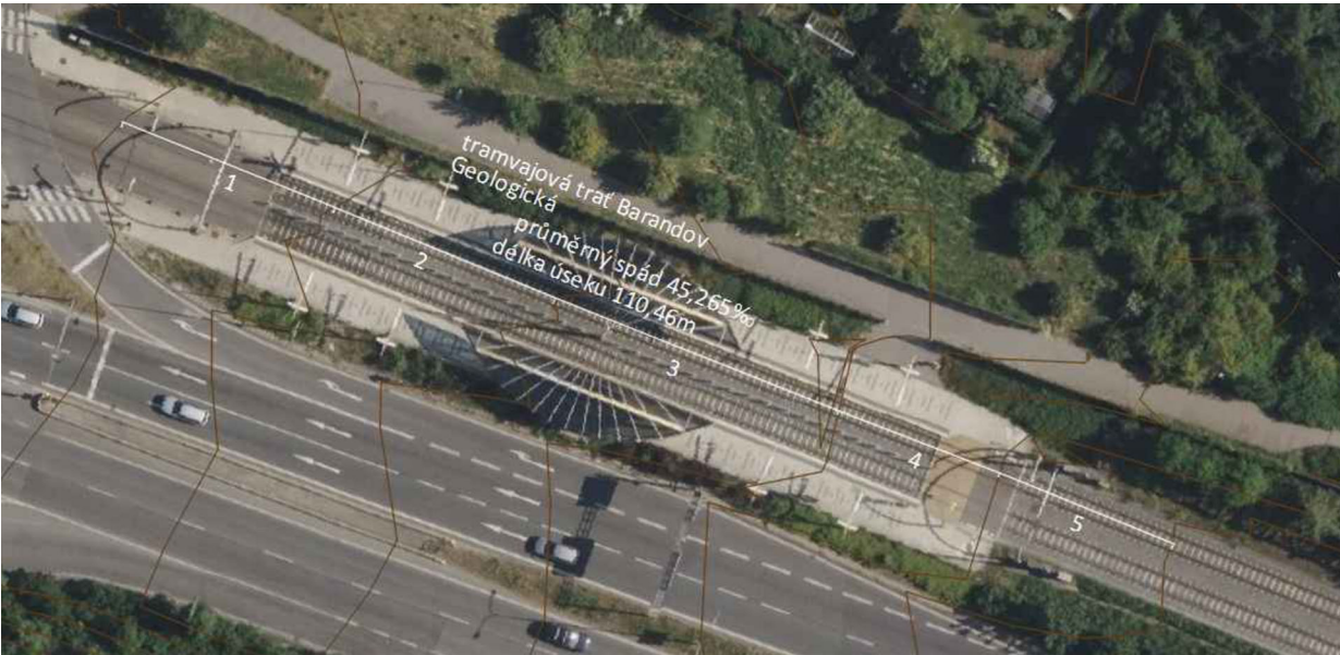
Sesazení vrstevnicového plánu zastávky Geologická a dopočet jejího sklonu.
